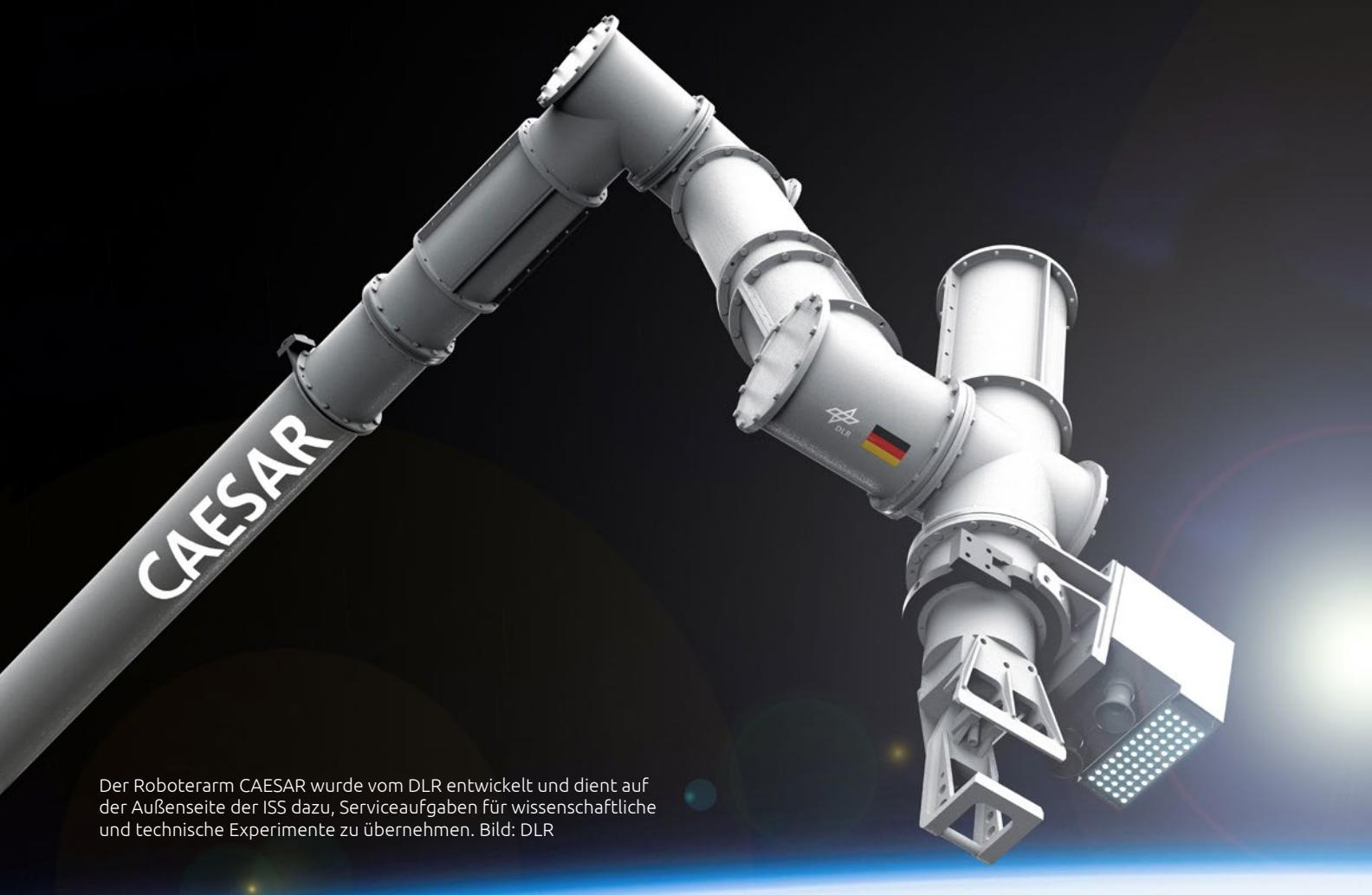
Der Roboterarm CAESAR wurde vom DLR entwickelt und dient auf der Außenseite der ISS dazu, Serviceaufgaben für wissenschaftliche und technische Experimente zu übernehmen. Bild: DLR
