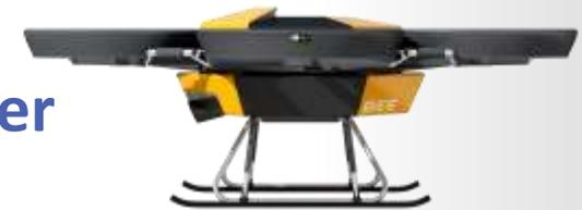
Der BEE-H6 Heavy Lifter wird die über die DroneIntelligence-Software steuerbare Flotte zukünftig erweitern. Aufbauend auf den bestehenden flugerprobten Prototypen werden zukünftig skalierbare Versionen mit Traglasten von 50-200 kg entwickelt und für den weltweiten Markt produziert. Der BEE-H6 bietet vielfältige Nutzungspotentiale Transport-, Rettungs-, Inspektions- und Unterstützungsaufgaben für zivile wie militärische Anwendungen.
