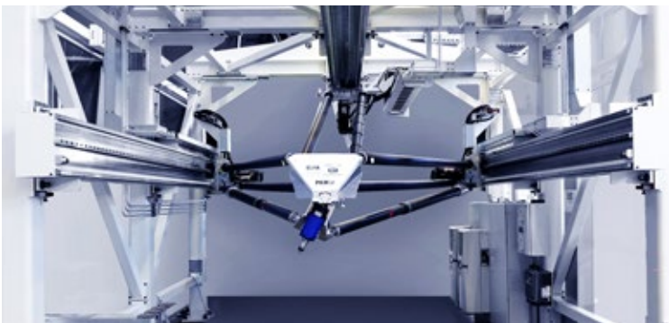
Abbildung 19: Parallelkinematik-Modul (PKM) von ELHA-MASCHINENBAU Liemke KG und Cognibotics AB
