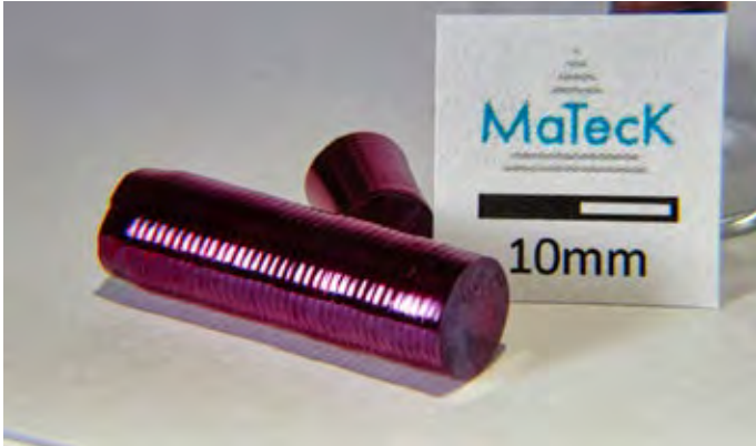
Lanthanhexaborid Einkristalle unterschiedlicher Dimensionen. Credits: MaTeCK GmbH
