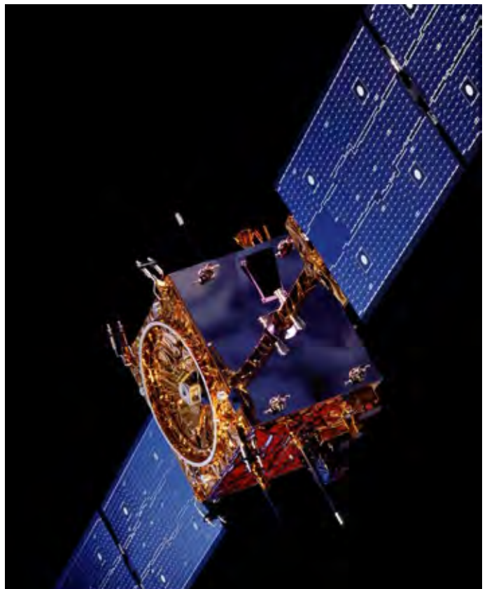
SMART-1 Mondsonde der ESA. In der Mitte des goldenen Kubus sitzt der Plasmaantrieb mit \text{LaB}_6 Einkristall. Credits: ESA
