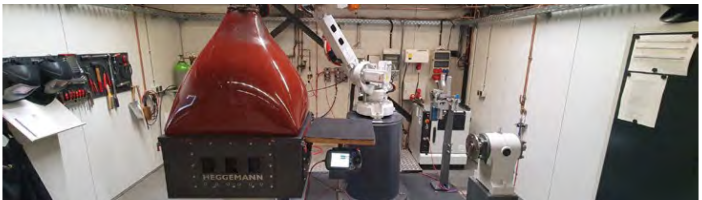
Robotergeführte WAAM-Anlage (6 + 2 Achsen) mit Schutzgaszelt und angeschlossener Sensorik zur Prozessüberwachung.
