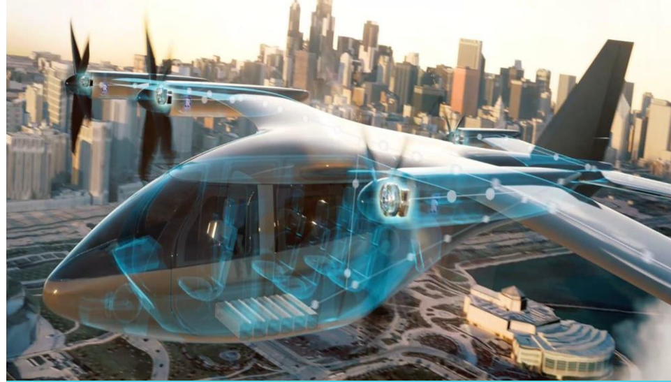
Elektrisches Antriebsaggregat, Stromverteilung und Energiespeichersystem für urbane Luftmobilität
