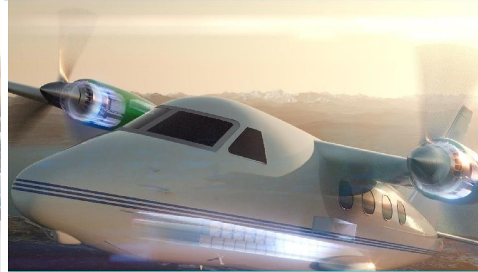
Elektrisches Antriebsaggregat, Stromverteilungs- und Energiespeichersystem für elektrische Pendlerflugzeuge
