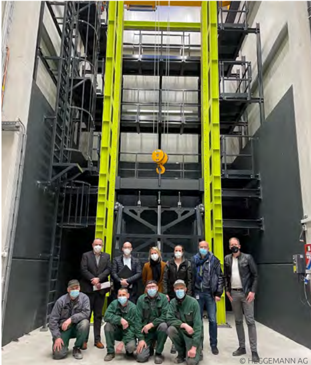
Drop Test Stand für Strukturen und Fahrwerke von Flugzeugen mit einer Fallhöhe von bis zu 8 m und einer Fallmasse von bis zu 15 t
