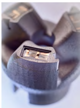
Führendes Werkzeug der Zukunft: Ein Fräskopf mit integrierter Sensorik zur Temperatur- und Druckmessung. © Fraunhofer ILT, Aachen.
