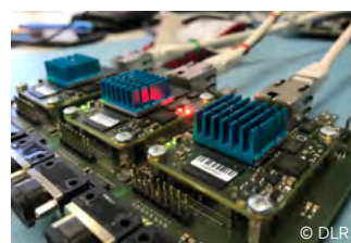
Labormodell der verteilten Rechnerarchitektur „ScOSA“ © DLR
