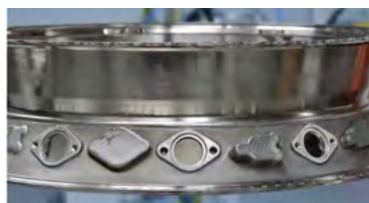
Aufgeschweißte Geometrien auf MTU-Demonstrator „Turbinenzwischengehäuse“
