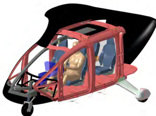
CFK-lastiger Strukturentwurf der SkyCab-PTU
